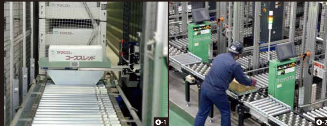
トレーを活用することで、バケットと比べ、保管スペースを大幅に削減。
