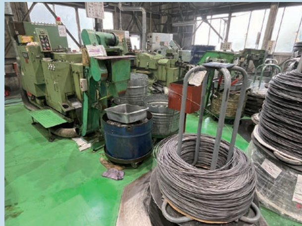
ネジ頭を加工するヘッダー加工機
