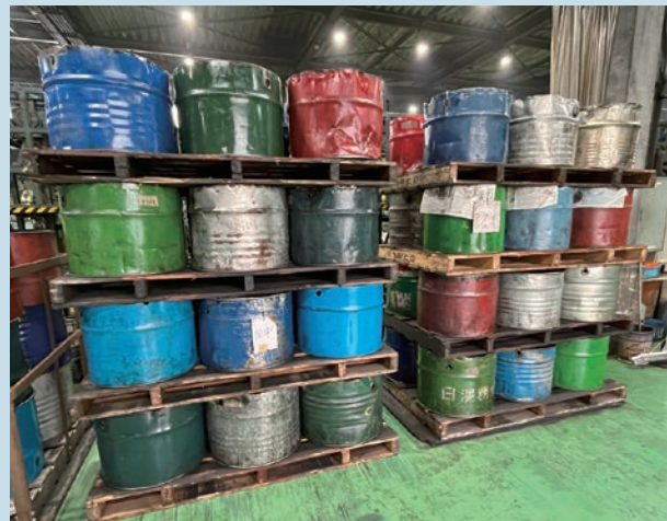
成型加工を終えた大量のネジは、熱処理→電気亜鉛メッキ→三価クロレート処理を行うため、加工専門業者へと送られる
