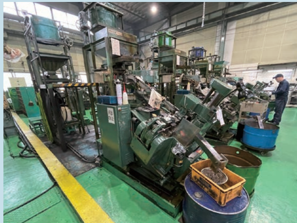
ネジのドリル刃先を加工するフォーマー加工機
