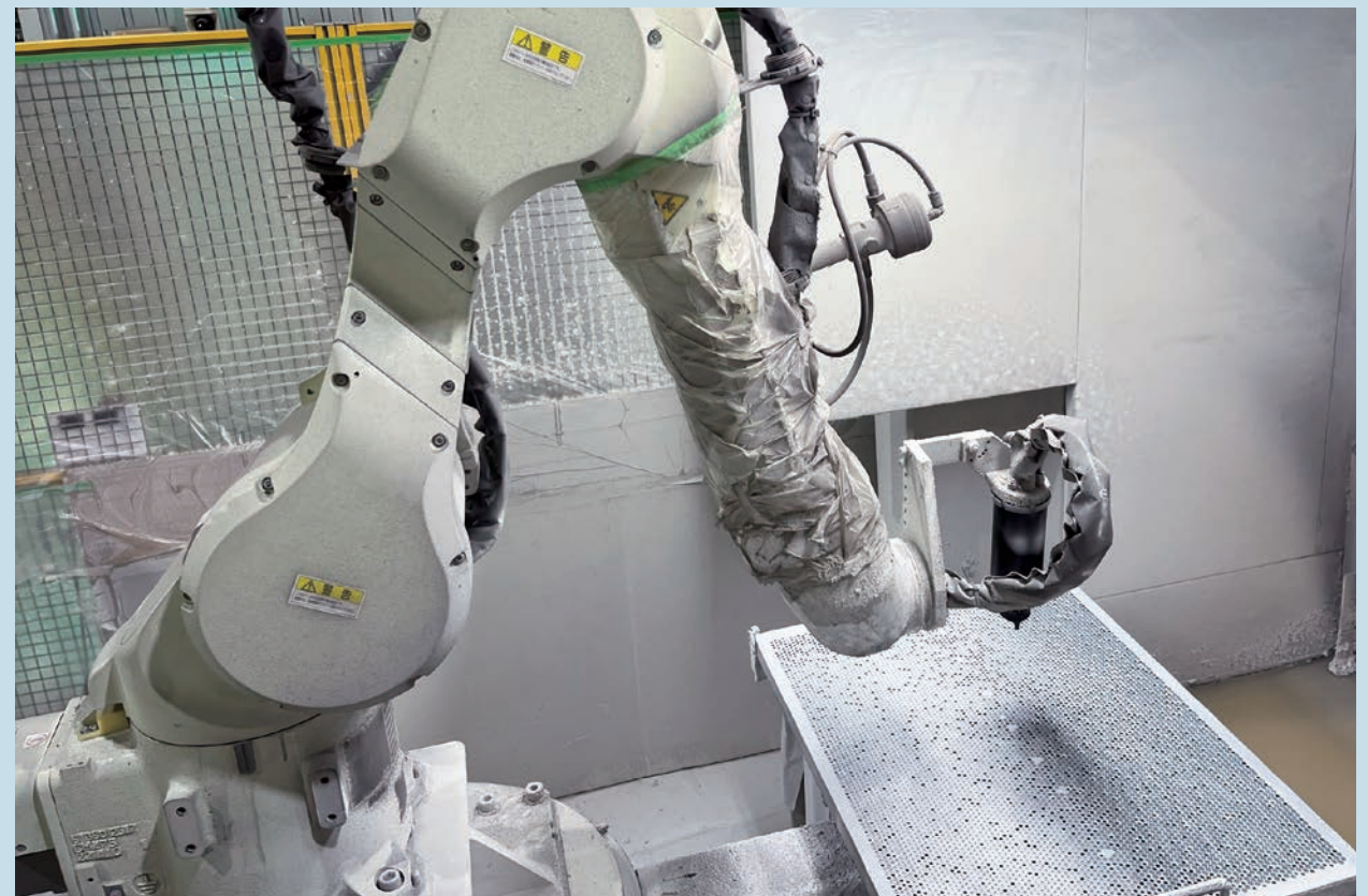
塗装ロボットに最適なエア静電自動ガン・ロボガンⅢ・EAB400を装着したロボット塗装システム
