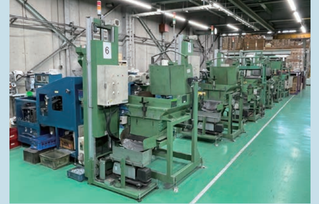
ネジの品質を検査するネジ選別機(画像認識/センサー認識)
